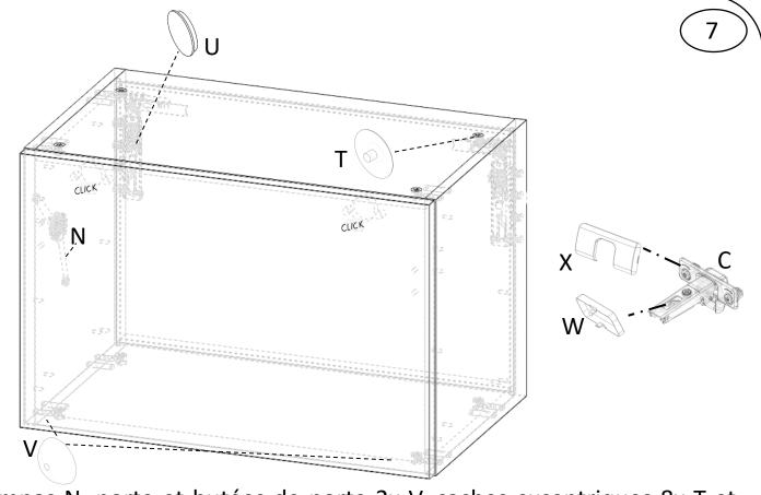
Montage compas N, porte et butées de porte 2x V, caches excentriques 8x T et caches suspension murale 2x U après pose et réglage, caches bras 2x W et caches boitier 2x X
