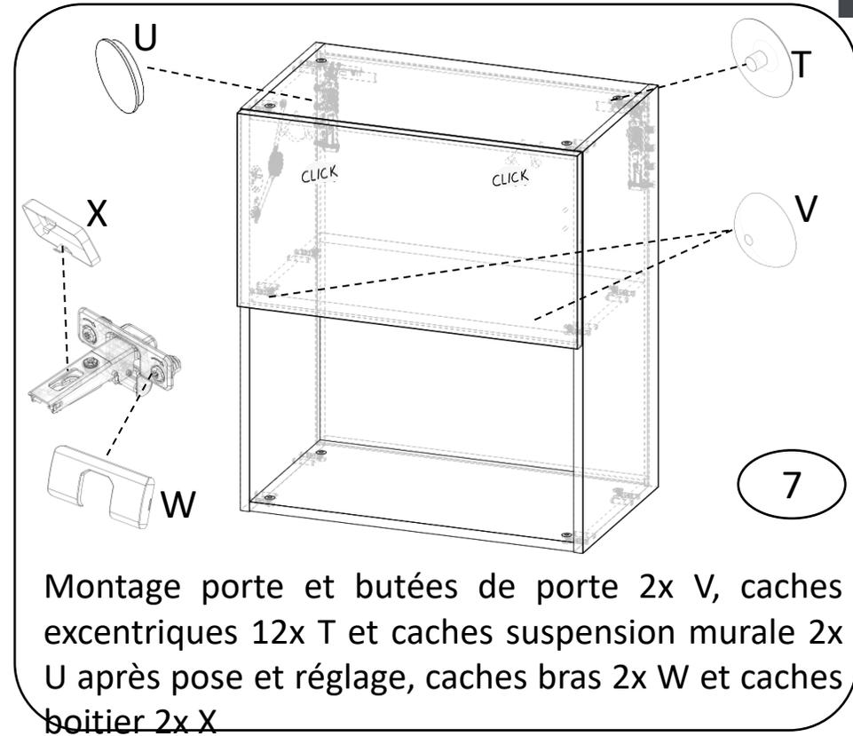
Montage porte et butées de porte 2x V, caches excentriques 12x T et caches suspension murale 2x U après pose et réglage, caches bras 2x W et caches boîtier 2x X
