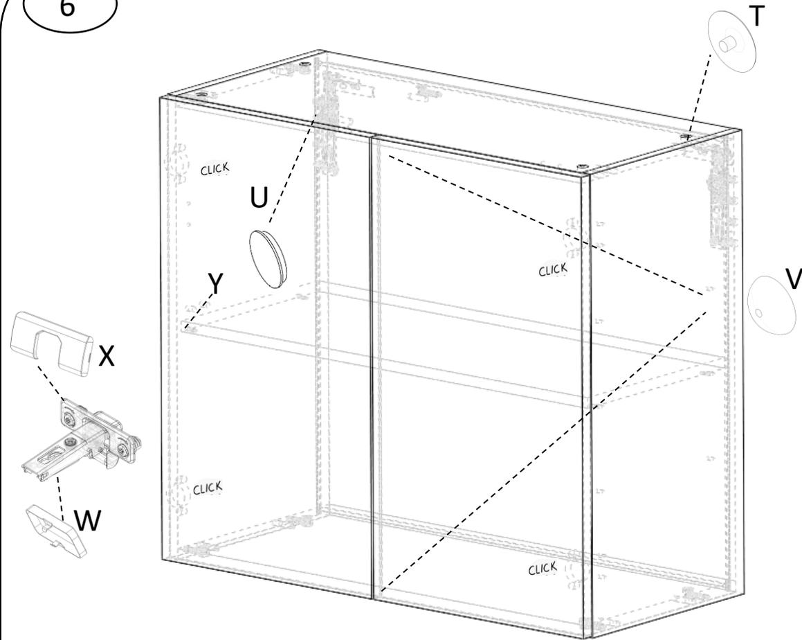
Montage portes et butées de porte 4x V, caches excentriques 8x T et caches suspension murale 2x U après pose et réglage, caches bras 4x W et caches boîtier 4x X puis des taquets étagère 4x Z pour sa pose.
