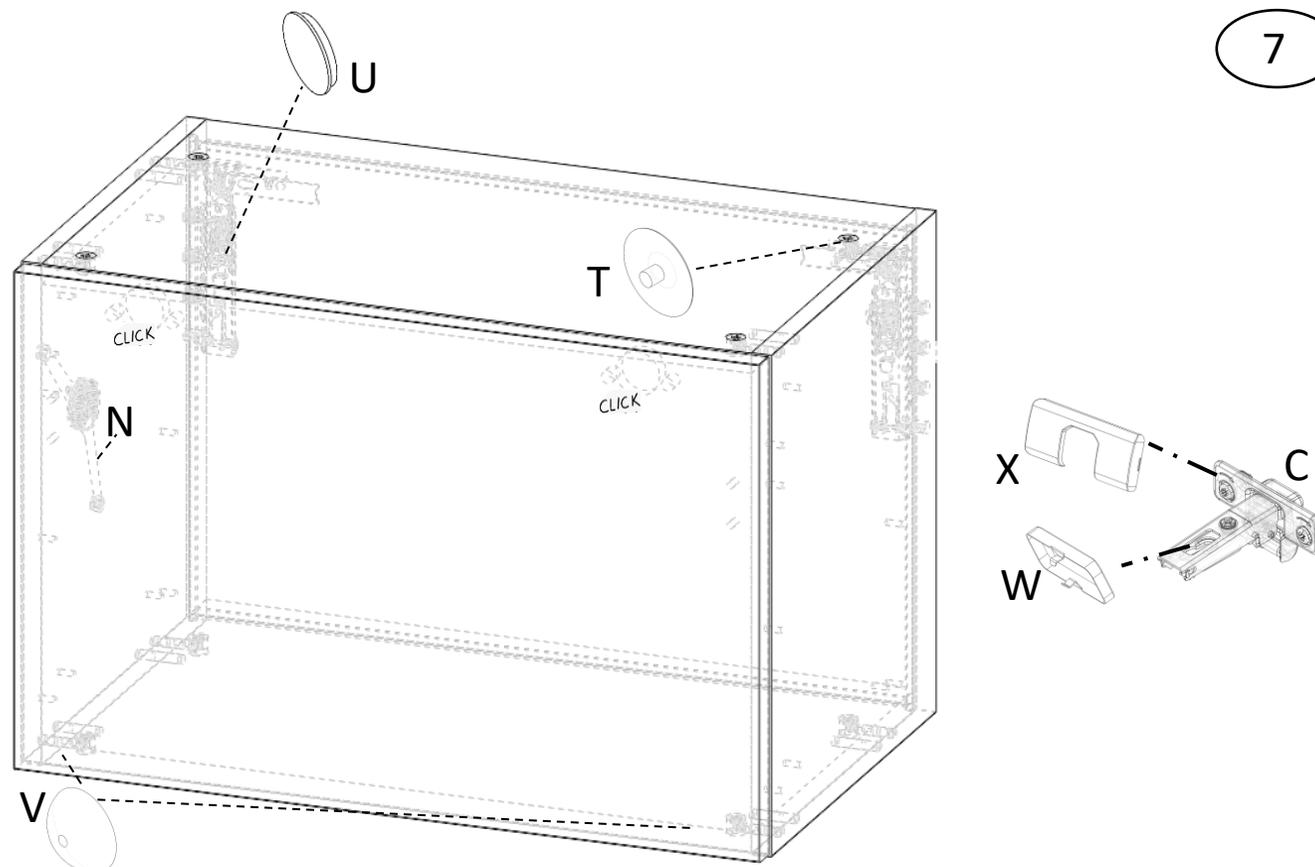
Montage compas N, porte et butées de porte 2x V, caches excentriques 8x T et caches suspension murale 2x U après pose et réglage, caches bras 2x W et caches boîtier 2x X
