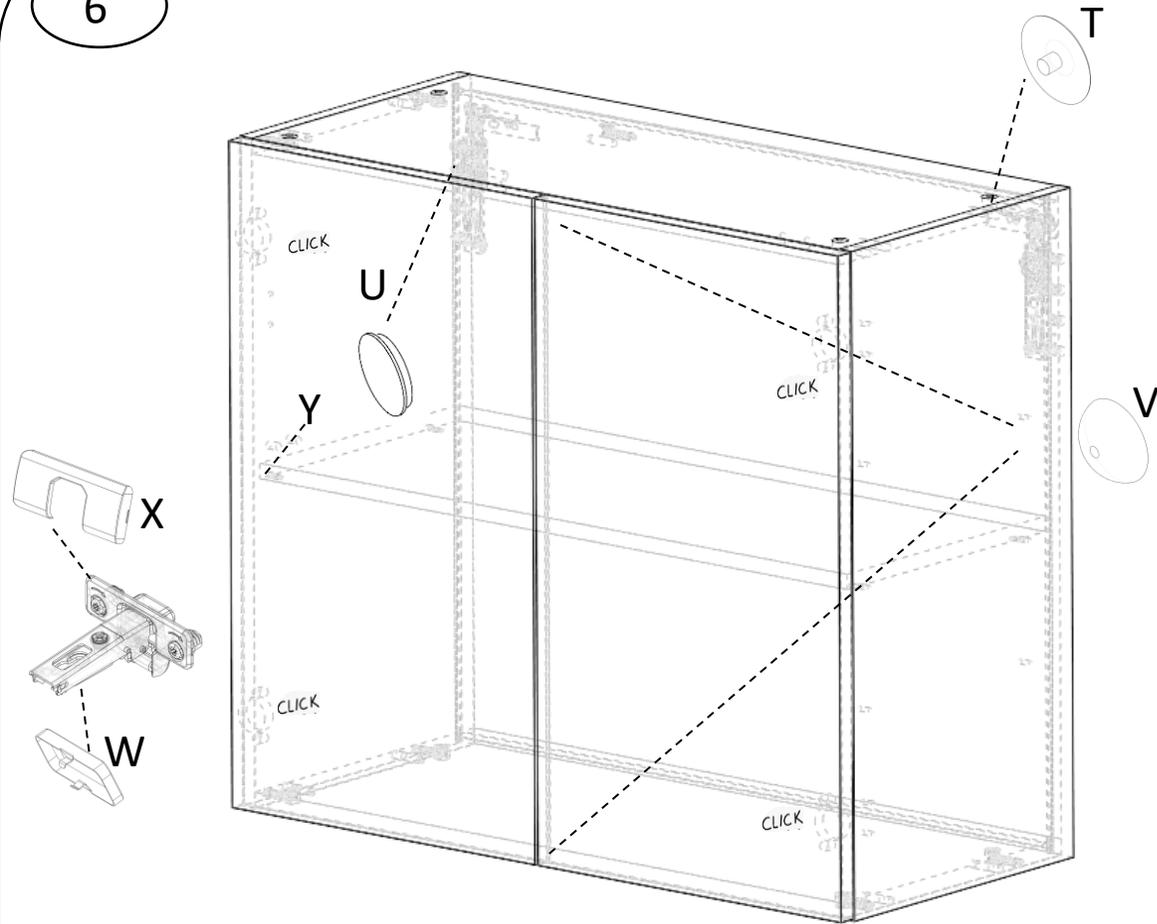
Montage portes et butées de porte 4x V, caches excentriques 8x T et caches suspension murale 2x U après pose et réglage, caches bras 4x W et caches boîtier 4x X puis des taquets étagère 4x Z pour sa pose.
