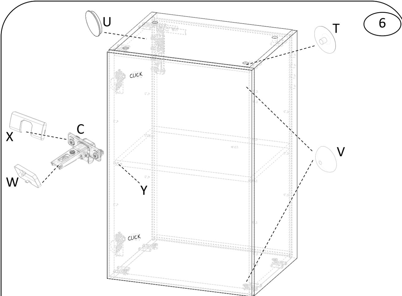
Montage porte et butées de porte 2x V, caches excentriques 8x T et caches suspension murale 2x U après pose et réglage, caches bras 2x W et caches boîtier 2x X puis des taquets étagère 4x Z pour sa pose.
