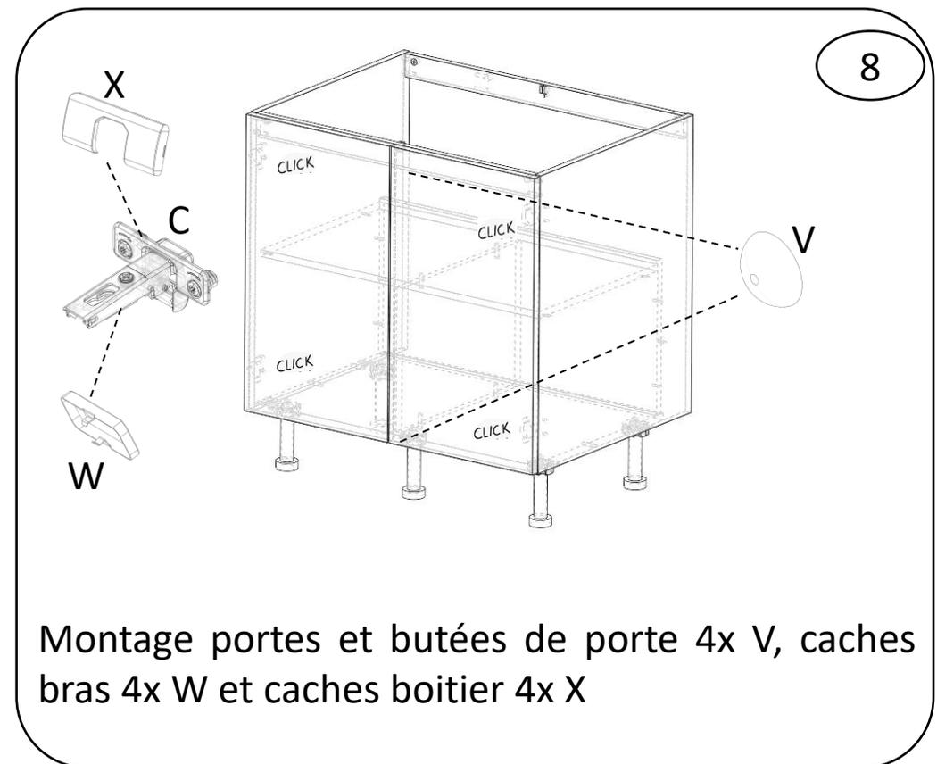
Montage portes et butées de porte 4x V, caches bras 4x W et caches boîtier 4x X
