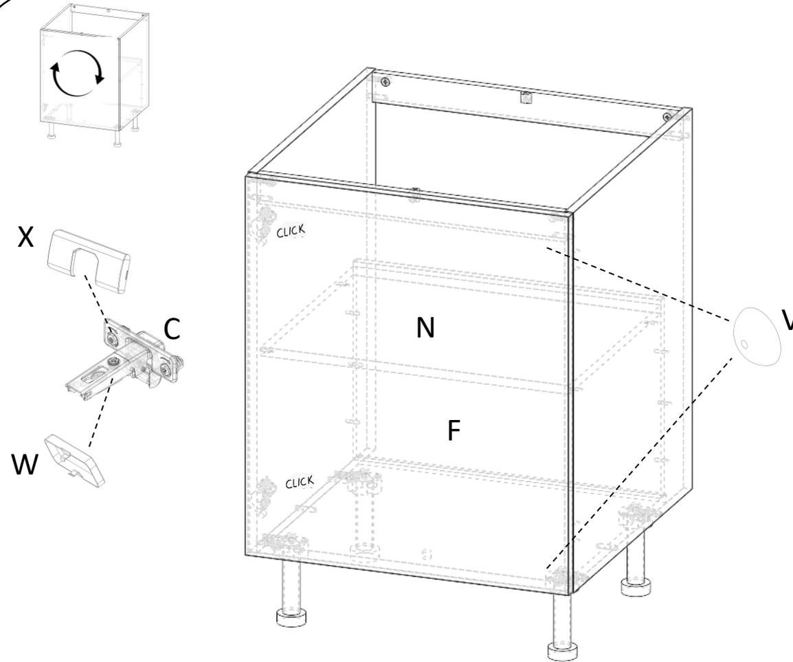
Montage porte et butées de porte 2x V, caches bras 2x W et caches boîtier 2x X, glisser le fond F entre les taquets à la verticale poser l'étagère N sur les taquets
