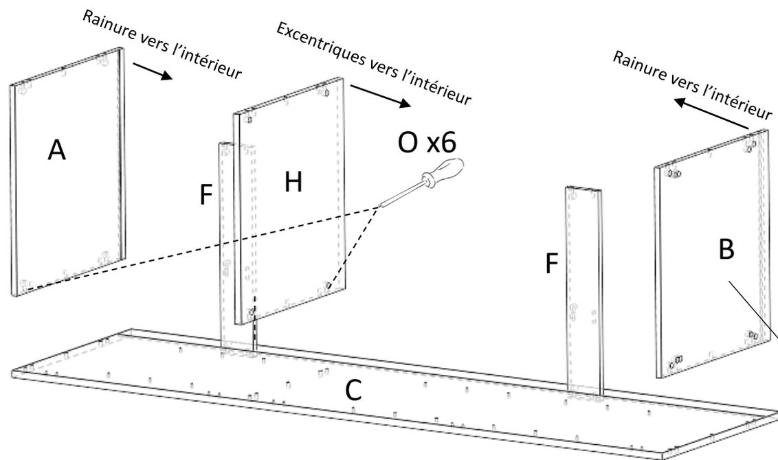
6 Glisser le médium 3mm E dans les rainures des pièces A et B (sur le modèle passage frigo en bas, le médium est à glisser entre A et H)
