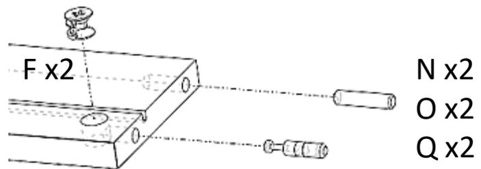
4 Monter les traverses F sur le coté C excentriques
